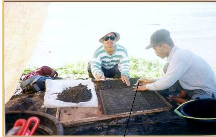
Gambar 4. Teknik Penyontohan Pasir Besi Metoda Increment
