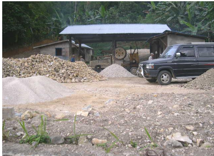
Foto 1. Tempat penggilingan batugamping menjadi kerikil (split) di lokasi sekitar Ds. Alasa dan Gunungsitoli.
