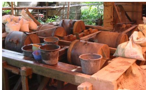
Gambar 4. Tromol untuk amalgamasi emas menggunakan tenaga air, Boalaang Mongondow, Sulut
