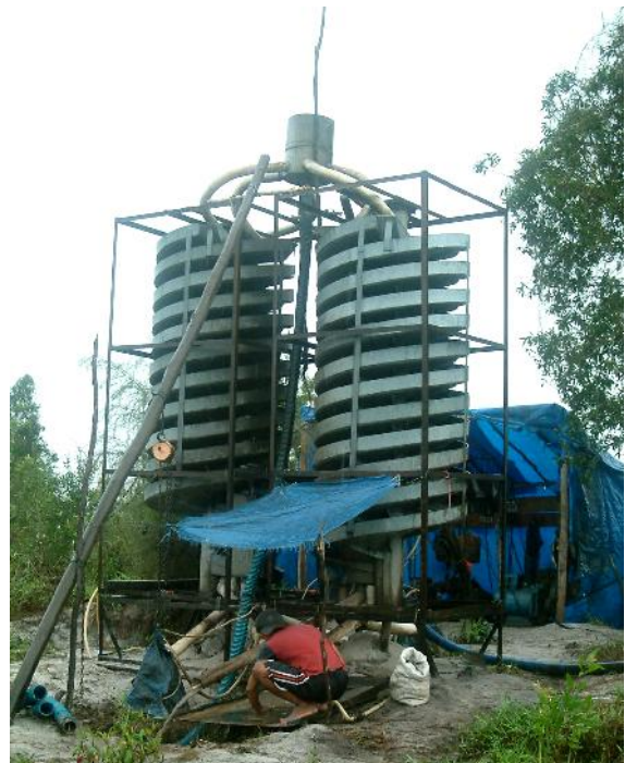
Gambar 9. Pengolahan zirkon dari tailing tambang timah putih, Belitung, Babel (Widhiyatna dkk, 2006)
