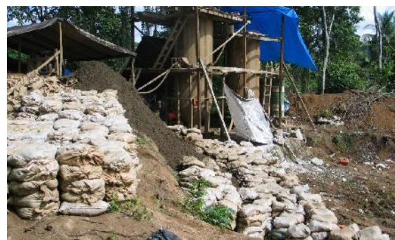
Gambar 5. Tailing hasil pengolahan bijih emas sistim amalgamasi, diolah kembali dengan sistim sianidasi, Halmahera Utara
