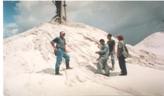
Gambar 2. Tailing berupa pasir kuarsa hasil penyaringan kaolin, Belitung, Babel (Ishlah dkk, 2002)
