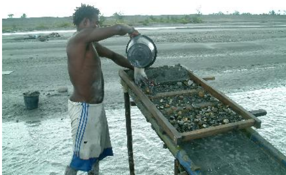
Gambar 3. Pengolahan emas dari tailing tambang tembaga, Mimika, Papua
