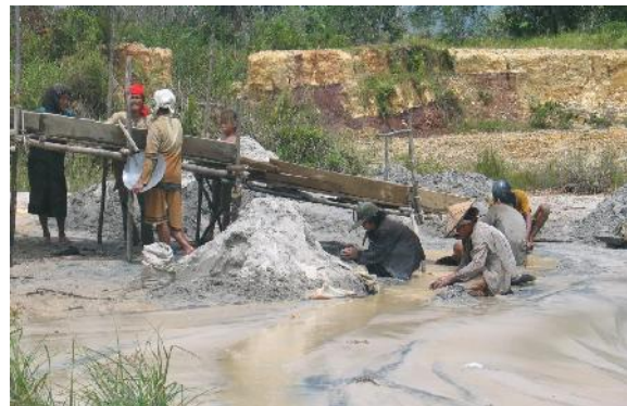
Gambar 7. Penambangan ilmenit dari tailing tambang emas aluvial, Monterado, Kalbar
