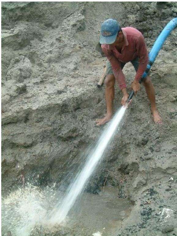
Gambar 8. Penambangan timah putih dari tailing tambang timah putih, Belitung (Widhiyatna dkk, 2006)
