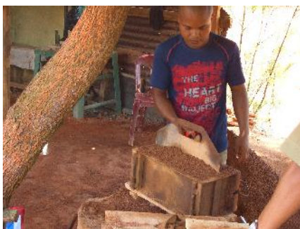
Foto 3. Pembuatan paving block dan batako dengan alat sederhana, bahan dari tailing hasil pengolahan bauksit di P. Bintan (foto MPPohan, 2007)
