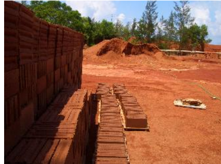
Foto 4. Batako bahan dasar tailing hasil pengolahan bauksi ( foto MPPohan, 2007)
