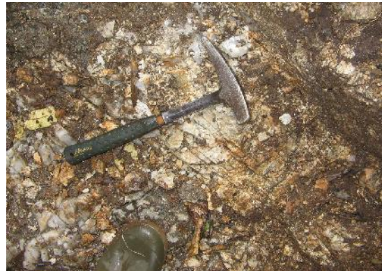
Foto 2. Jenis urat kwarsa “sugary” kedudukan N150^\circ E/30^\circ (AT/PR 1 / 2/Fi) di Ujung Ladang, Siulak Deras Mudik.
