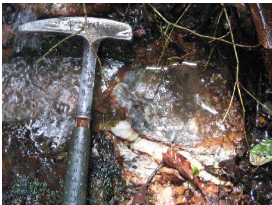
Foto 1. Jenis conto urat kwarsa kedudukan N160^\circ E/60^\circ pada batuan andesit di S. Telun Siulak Deras Mudik (lokasi conto STL/02/R/03/Fi dan STL/02/R/02/AT).
