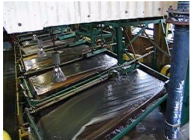
Gambar 7. Meja goyang untuk pemisahan mineral berat, Koba, Bangka Tengah
