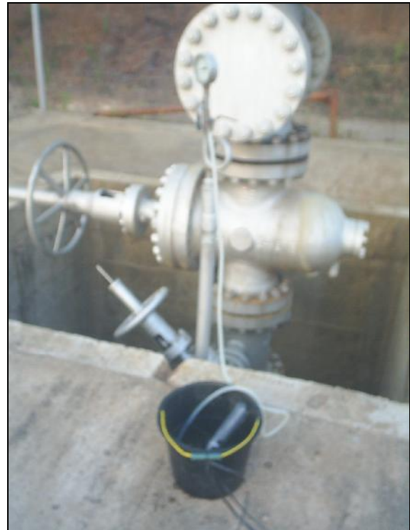
Gambar 6. Instalasi pengambilan sampel gas sumur Eksplorasi AT-1 Lapangan Panas Bumi Atadei, Lembata, NTT
