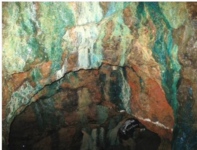
Gambar 6. Malakit, Azurit dan hematit sebagai mineral sekunder tembaga dan besi, selain itu terdapat juga kalkopirit dan galena, mineralisasi ini terbentuk di dalam batuan terkersikkan, terpatahkan di dalam lobang tambang Lobang Baru pada level 3.
