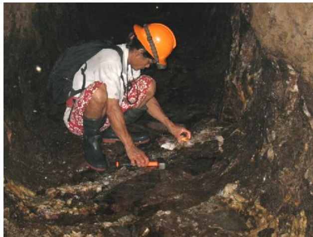
Gambar 5. Pengambilan conto batuan berupa breksi kuarsa di dalam ubahan terkarsikan kuat sehingga banyak ditemukan urat-urat kalsedon dengan struktur koloform dengan dilapisi oleh khlorit berwarna kehijauan, bersama pirit halus dan galena serta pirolusit, terbentuk di dalam lubang/ tunnel .
