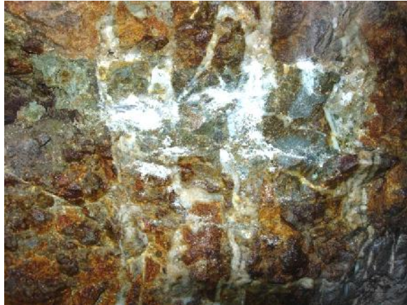
Gambar 4. Batuan vulkanik andesitik terkoyakkan diisi breksi kuarsa yang mengandung emas dan perak, cebakan emas yang terbentuk di dalam urat kuarsa pada umumnya berasosiasi dengan pita-pita khlorit.
