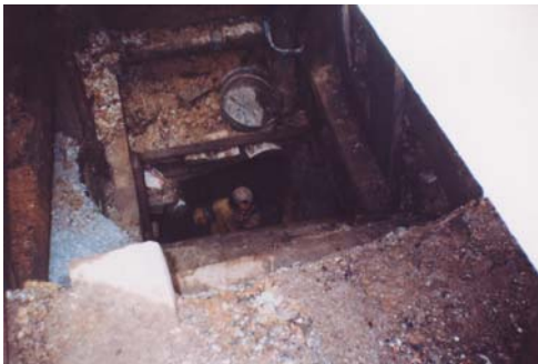
Foto 7. Lokasi Lobang tiga belas yang digali secara tradisional yang digunakan oleh para PETI untuk mendapatkan urat-urat yang mengandung logam mulia emas dan perak.
