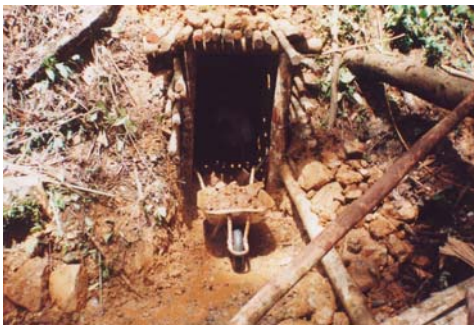
Foto 6. Alat angkut yang sangat sederhana untuk membawa batuan yang telah Dikeluarkan dari lobang untuk dibawa ke tempat gelondong
