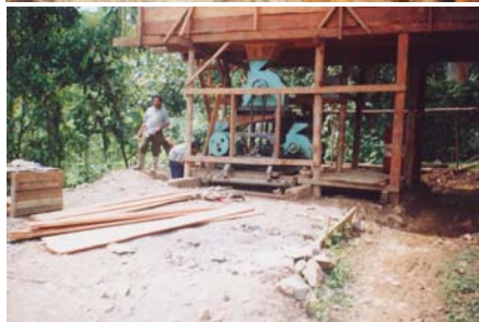
Foto 4. Mesin pemecah batu crusher yang digunakan oleh PETI dekat Lobang tiga belas.
