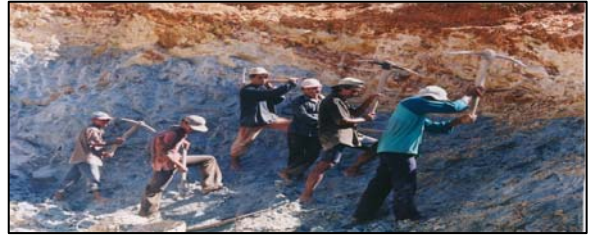
Penambangan bentonit secara manual, hasilnya tidak efektif dan tidak optimal di Karangnunggal.
