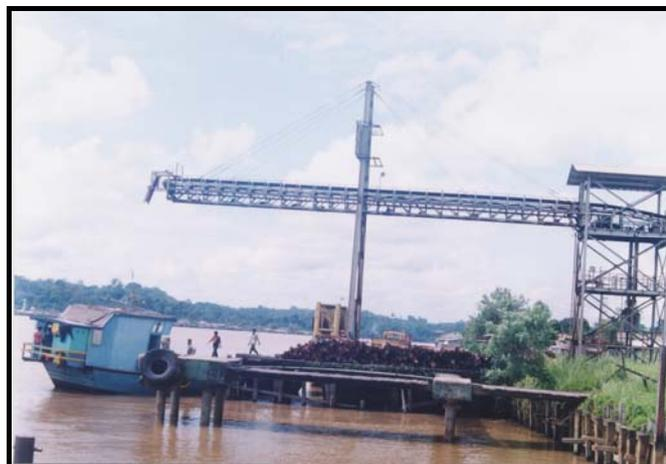
Foto.6 Belt Conveyor untuk mengangkat batubara dari stock pile ke tongkang pengangkut batubara di tepi S.Mahakam.
