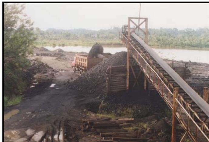
Foto 3 Belt Conveyor yang dipergunakan untuk mengangkut batubara dari tambang dalam seam "D", kemudian diangkat oleh dump truck untuk diolah sesuai dengan ukuran yang diinginkan.
