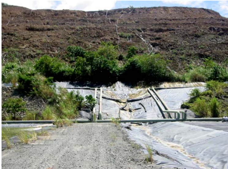
Foto 2. Proses Heap Leach di PT. Newmont Minahasa Raya, Ratatotok
