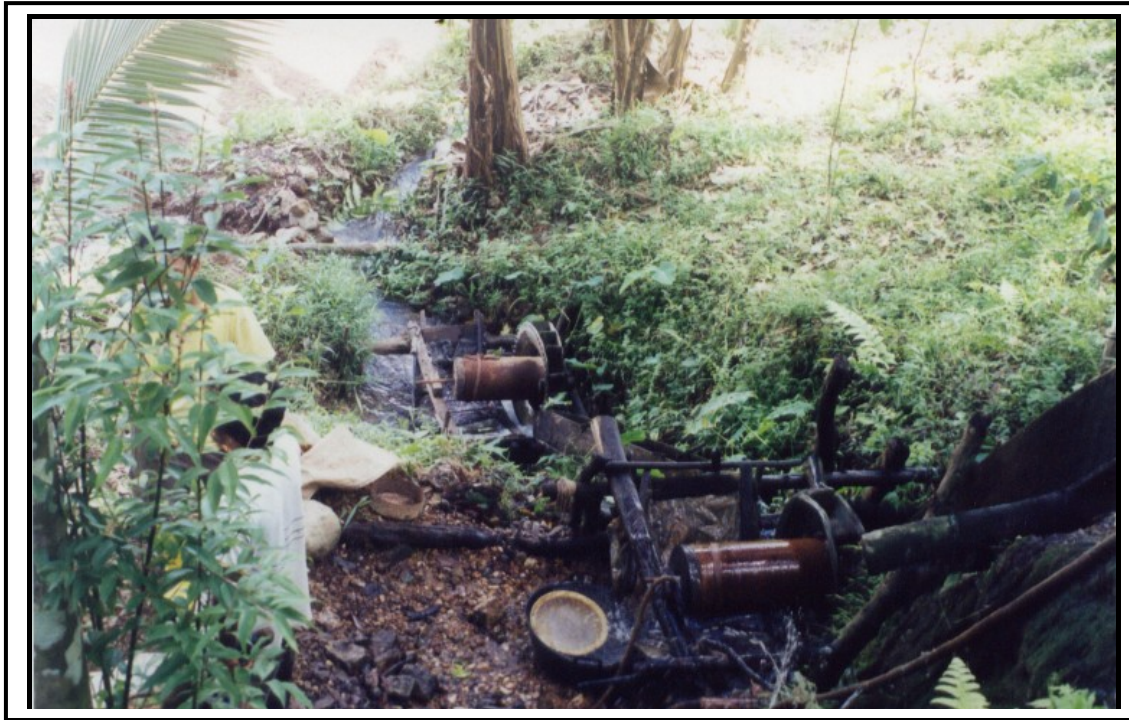
Foto 6. Pengolahan Emas (PETI) memanfaatkan saluran air sebagai tenaga penggerak
