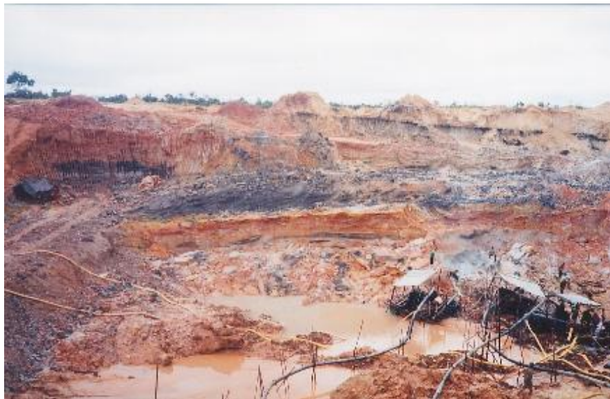
Foto 1. Sistem penambangan semprot dan isap pada lapisan aluvial di lokasi tambang PT. Kapuas Aluvial Jaya
