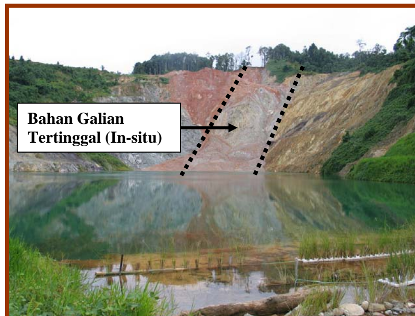
Gambar 5. Pit Gosowong yang ditinggalkan, terlihat bijih/ore tersisa pada dinding bagian selatan. (Situasi Agustus 2005).
