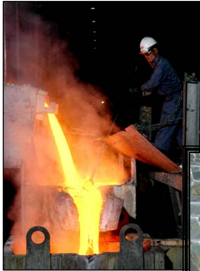
Foto 5 Proses Peleburan Bijih Timah Di Pabrik Smelter PT.Koba Tin dan Hasil Cetakan Balok Logam Timah (Ingot)
