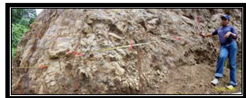
Foto 1. Singkapan Mineralisasi Salosi yang memperlihatkan urat kuarsa baratlaut – tenggara mengandung pirit, arsenopirit, lokasi KM 11,6 poros jalan Maligano-Ronta .
