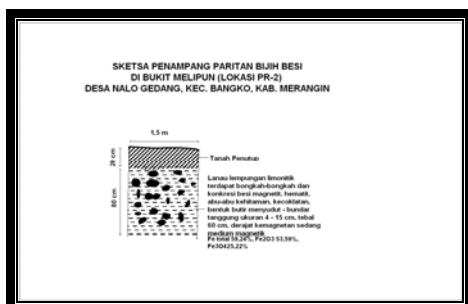
Gambar 12. Penampang Paritan PR-2, Bukit Melipun, Nalo Gedang, Kab. Merangin
