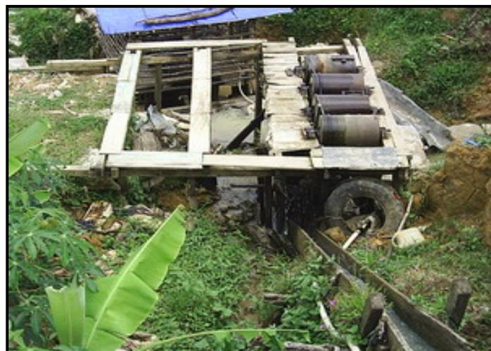
**Gambar 3.** Gelundung yang digunakan PETI untuk mengolah bijih emas di daerah Pasir Jawa
