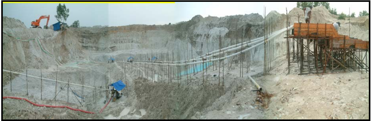
Gambar 3 Pertambangan timah aluvial di Tambang Inkonvensional Desa Teluk Dalam dengan bukaan 30 m x 50 m x 7 m. Metode penambangan dengan cara tambang semprot. (lokasi TI Desa Teluk Dalam, Kec.Tanjung Pandan)
