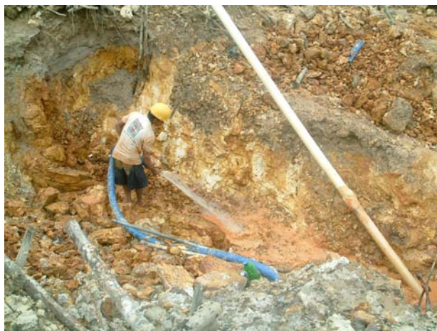
Gambar 4 “Sakhan” ukuran kecil sebagai alat untuk menangkap mineral berat dalam tailing seperti : kasiterit, zirkon, monasit dll yang terdapat pada tailing. (lokasi Desa Teluk Dalam, Kec.Tanjung Pandan)
