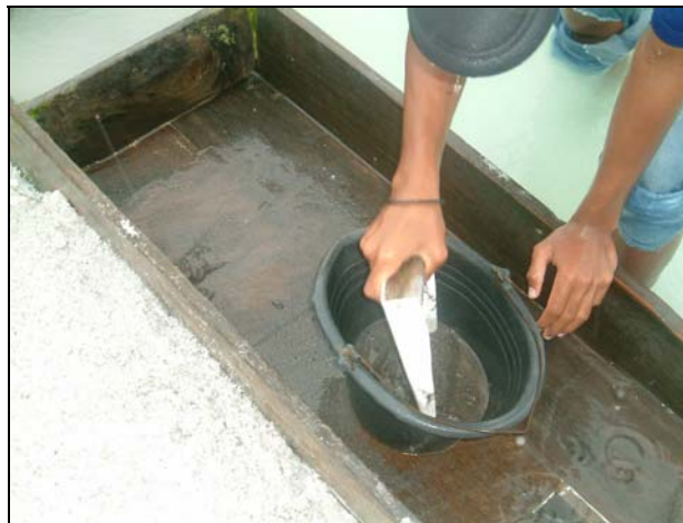
Gambar 4 “Sakhan” ukuran kecil sebagai alat untuk menangkap mineral berat dalam tailing seperti : kasiterit, zirkon, monasit dll yang terdapat pada tailing. (lokasi Desa Teluk Dalam, Kec.Tanjung Pandan)
