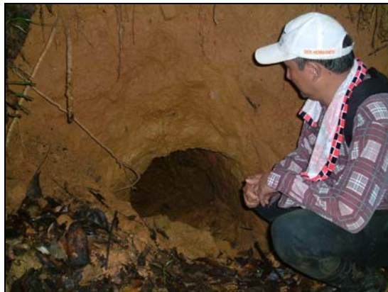
Gambar 7 Lubang tambang horisontal untuk mengambil material tanah. (Lokasi : Tambang Sergio).
