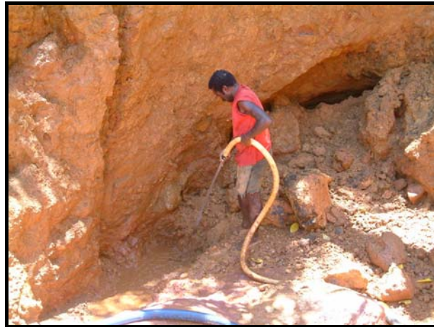
Gambar .6 Penyemprotan tanah laterit yang dialirkan ke dalam sluice box untuk memperoleh mineral berat dan emas (Lokasi : Tambang Bobi).
