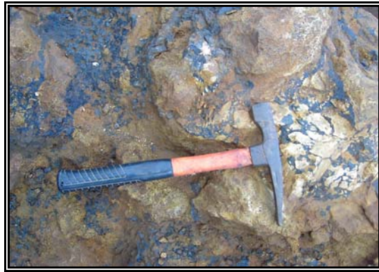
Foto 2. Bentuk stockwork menunjukkan mineralisasi mangan hidrotermal. Lokasi Galao C
