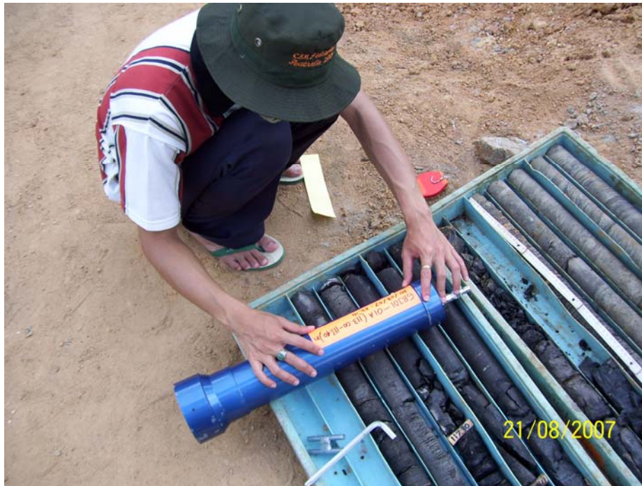
Foto 3. Core sampling dimasukkan ke dalam tabung canister
