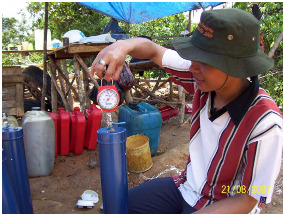
Foto 2. Pengukuran berat canister sebelum core dimasukkan
