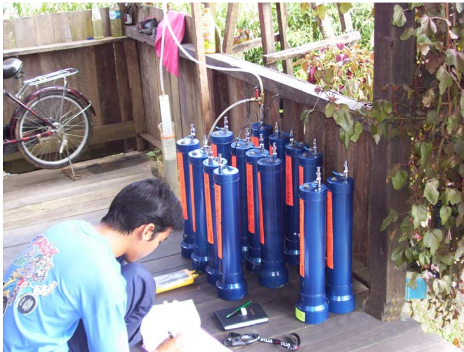
Foto 4. Pengukuran kandungan gas dalam canister secara paralel
