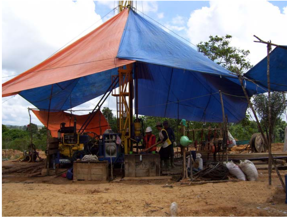
Foto 1. Lokasi pemboran dalam batubara disertai pengukuran kandungan gas dan packer-test batubara, lokasi PMG – 01
