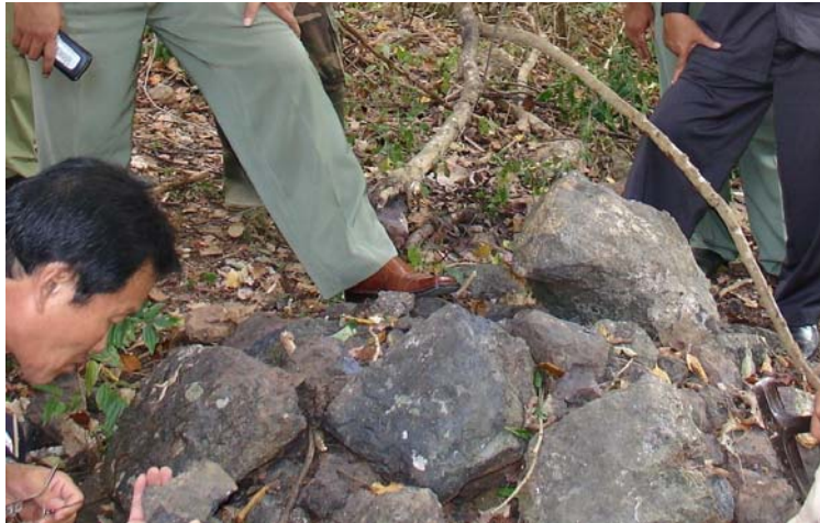
Foto 1. Bongkah-bongkah bijih Mn sebagai endapan kolivial di lingkungan batuan dasar breksi vulkanik, di kawasan hutan Desa Lepadi, Kecamatan Pajo
