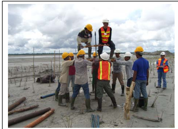
Gambar 5. Kegiatan pemboran dengan menggunakan bor bangka
