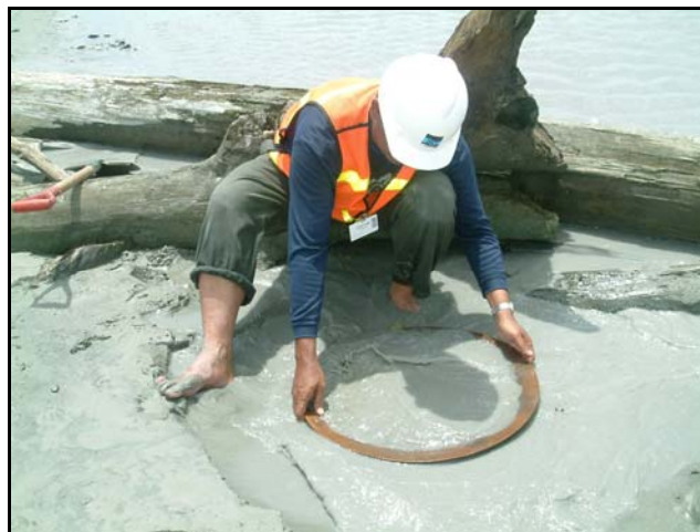
Gambar 6. Mendulang conto tailing dari pemboran untuk memperoleh mineral berat
