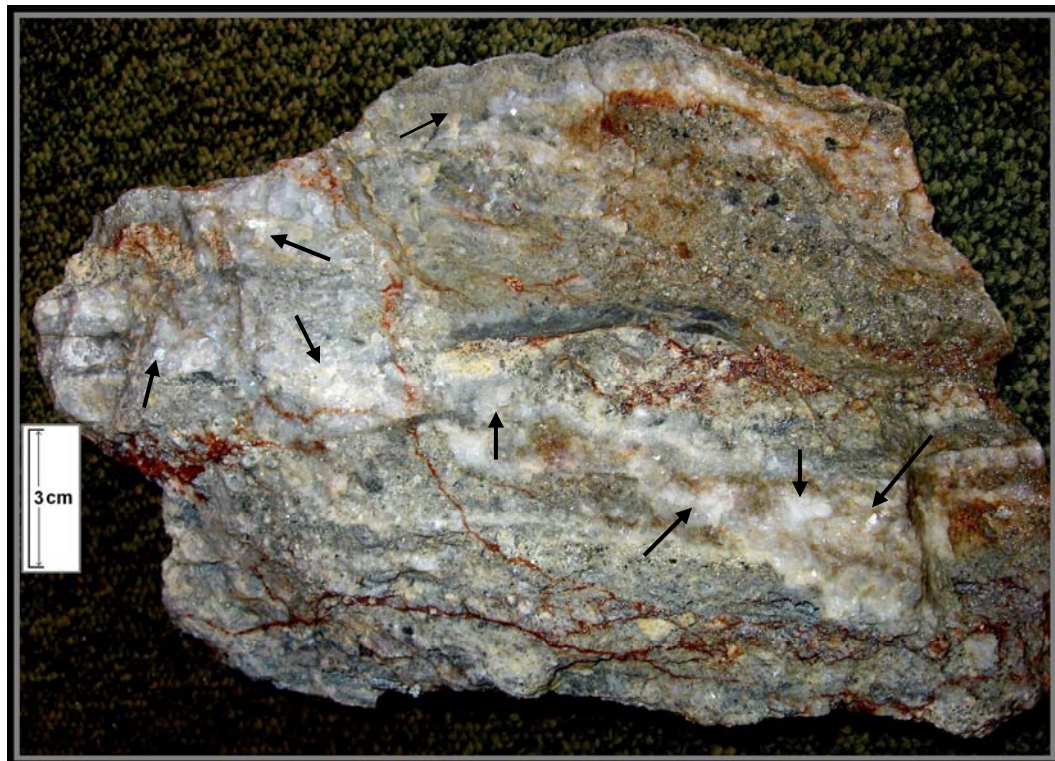
Foto 4 Urat kuarsa bertekstur ghost-bladed mengandung sulfida pada batuan terubah argilik dan limonitik (Kristal kuarsa bladed )
