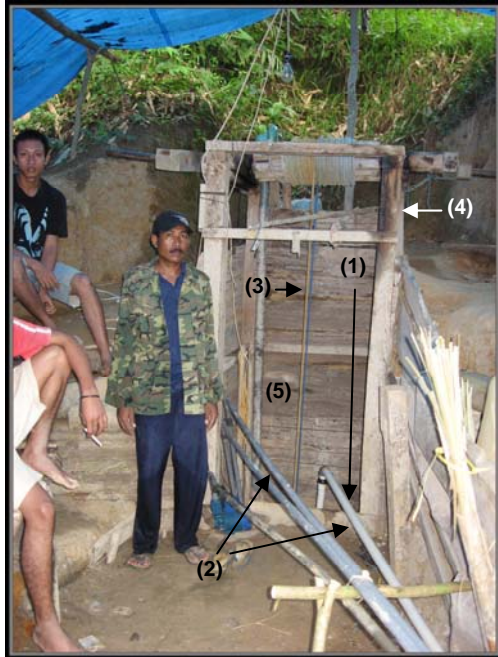
Foto 3. Contoh lubang tambang (serupa shafi ) yang umumnya dibuat oleh para penambang di daerah termineralisasi kawasan hutan lindung Taliwang. (1) Lubang tambang (2) Pipa pemompa air (3) Tali katrol pengangkut bahan galian (4) Kayu penyangga katrol (5) Papan penyangga dinding lubang tambang
