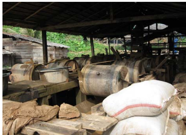
Foto 2. Tempat pengolahan emas yang dilakukan masyarakat dengan menggunakan gelundung
