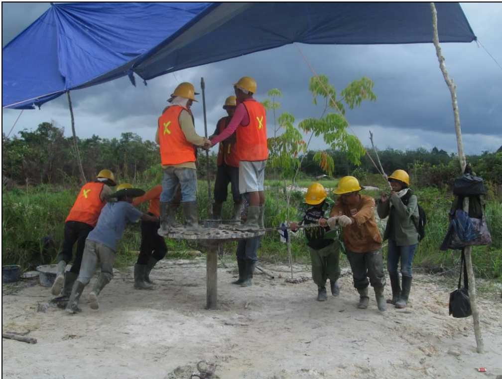
Gambar 4. Pengambilan conto bor menggunakan bor Bangka 4 inchi
