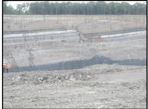
Gambar 8. Singkapan batubara dari Formasi Warukin ketebalan 2-3 meter di wilayah tambang PT. Karbon Mahakam
