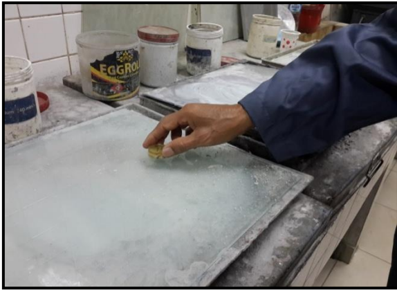
Pengasahan blok di atas pelat kaca dengan karborundum yang dicampur air
