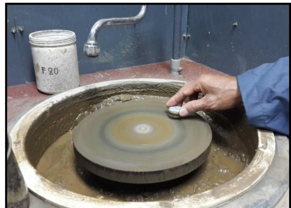
Pengasahan blok dengan piringan putar (Gerinda)
