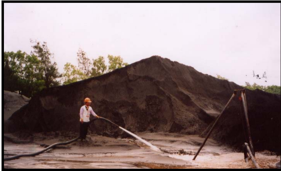
Foto 1 Bahan galian pasir besi hasil penambangan ( run of mine ) dalam persiapan untuk dikirim ke pemisah magnetik ( magnetic separator ) di Wilayah PT.Antam Tbk. Unit Pertambangan Pasir Besi Cilacap, Jawa Tengah
