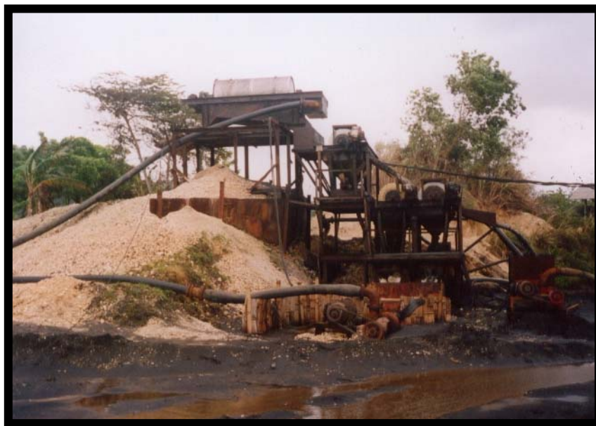
Foto 2 Alat pemisah magnetik ( magnetic separator ) bersusunan drum magnet berkekuatan 1.200, 1.000 dan 500 Gause berkapasitas 53,0 ton bahan galian/hari di Wilayah PT.Antam Tbk. Unit Pertambangan Pasir Besi Cilacap, Jawa tengah
