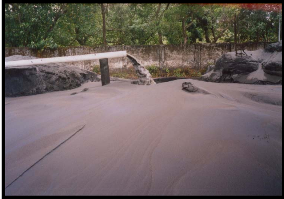
Foto 3 Penampungan konsentrat bijih besi setelah diolah oleh alat pemisah magnetik Di Wilayah PT.Antam Tbk. Unit Pertambangan Pasir Besi Cilacap Jawa Tengah
