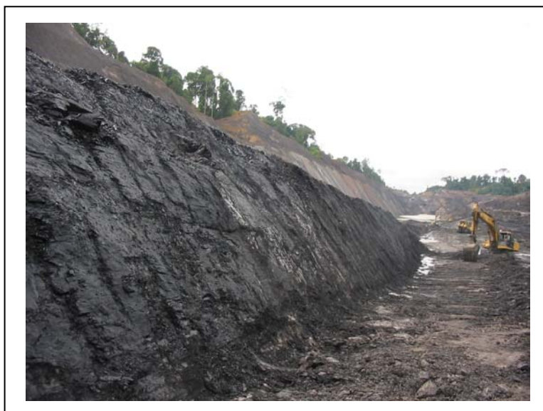
Foto 4 Kemiringan Lapisan Batubara di Sambarata (Sumber : PT Berau Coal)
