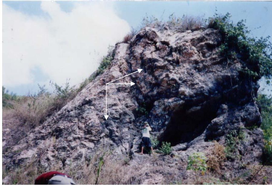
Foto 1 Kenampakan bijih mangan (Mn) Dalam bentuk pengisian bukaan/rekahan pada batugamping
