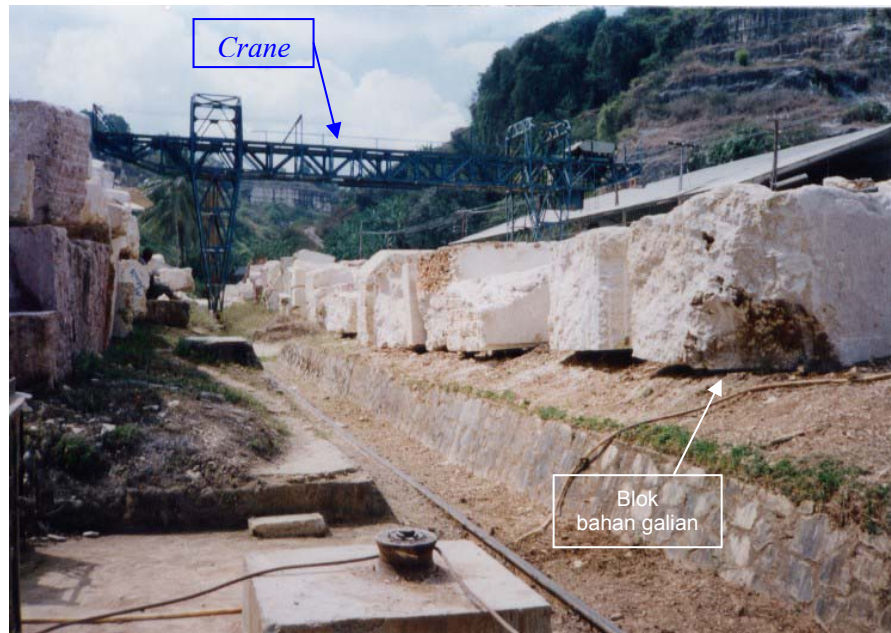
Foto 5 Peralatan pengangkut (crane) bahan galian marmer Di Wilayah Pertambangan PT. IMIT
