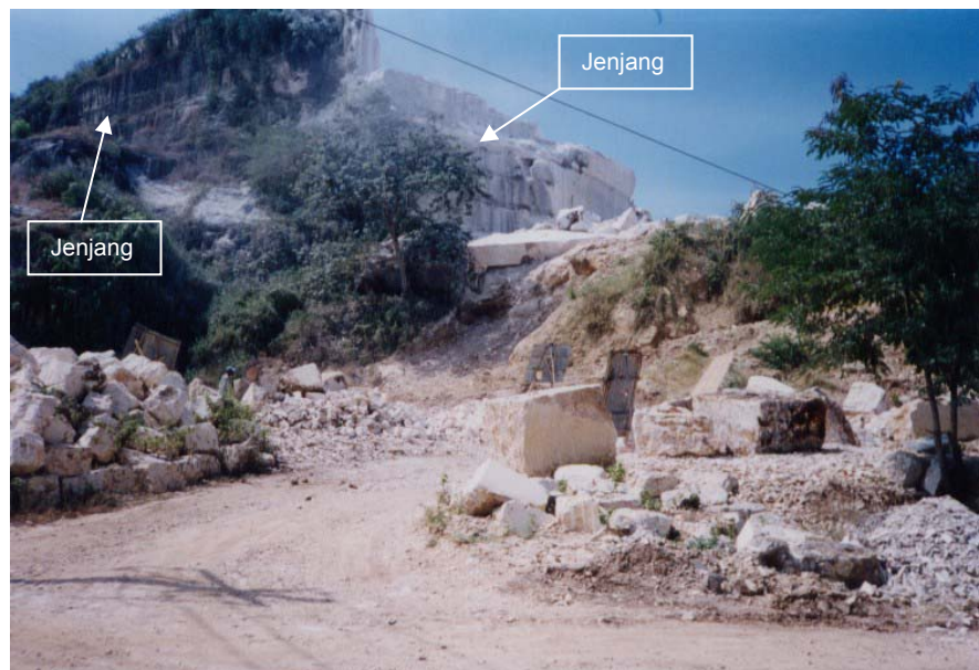
Foto 4 Penambangan bahan galian marmer dengan sistem tambang terbuka berpola medan berjenjang di Wilayah Pertambangan PT.Industri Marmer Indonesia Tulungagung (PT.IMIT)
