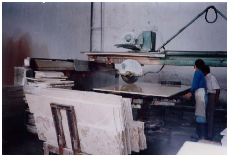
Foto 6 Mesin pemotong lembaran (slabs) marmer Di Unit Pengolahan PT. IMIT
