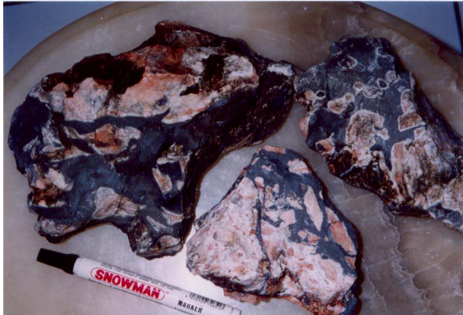
Foto 3 Close up bijih mangan (Mn) dari jenis pengisian ruang antar fragmen batugamping terbreksikan
